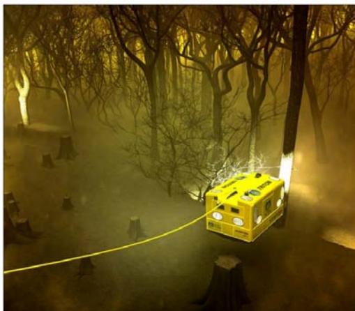
Der «Sägefisch» in Aktion: Diese Computeranimation zeigt, wie der kanadische Roboter Bäume in Stauseen fällt. Triton Logging
